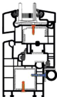
**СФЕРА ПРИМЕНЕНИЯ:** для крепления фурнитуры и металлических сердечников в ПВХ профилях, соединения ПВХ профилей с металлическим армированием, а также крепления фурнитуры и петель на профилях с металлическими элементами жесткости.
